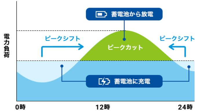
ピークシフトとは、「電気を使わない時間帯に電気を貯めておき、電気を多く使う時間帯に使用する」ことです。例えば、昼に多く電気を使う工場や会社の場合、夜、蓄電池に電気を貯めておきます。そして昼に使うことで、夜の安い電気で使うことができ電気代削減につながります。
